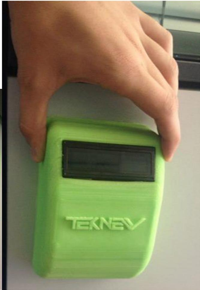
Con il software SolidWorks 2014 è stato progettato il contenitore ed infine ne è stato realizzato un prototipo con la stampante 3D.
